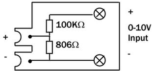
**2.5.4. Two-Wire Transmitter Inputs**
