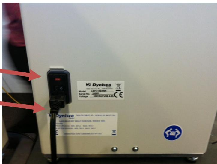
Figura 3: vista trasera del LMFI conexiones eléctricas
