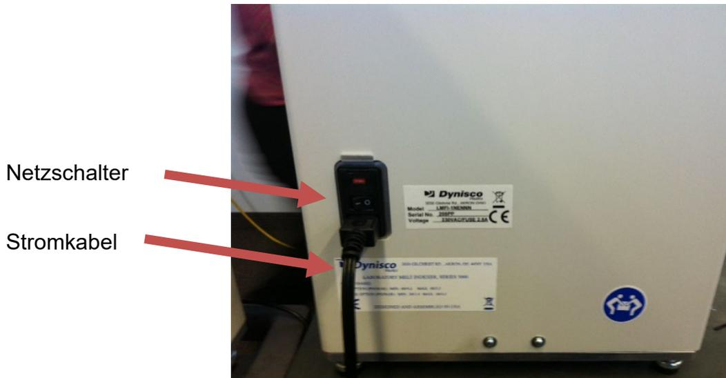
**Abb. 3: LMFI-Rückansicht, Stromanschluss**
