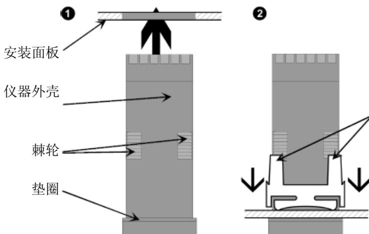
将仪器外壳上的安装夹子朝向安装面板的背面滑动，直到舌片进入棘轮，仪器被夹到适当的位置。
